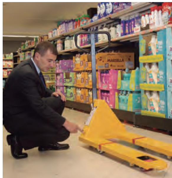
Alberto, responsable de Manteniment d'Astúries i Galícia, amb els portapalets amb sistema de molls d'elevació que ell va idear, en el supermercat El Fontán, a Oviedo.
