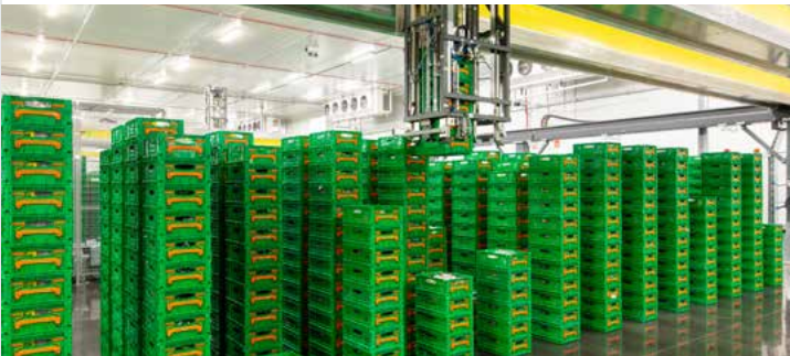
Sistema Picking Ponte Grúa (PPG) no bloque loxístico de Guadix, Granada.
